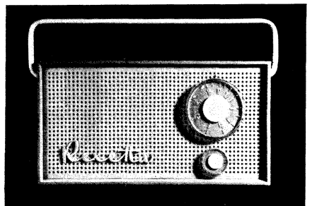
Bild 2. Taschensuper Rexetta mit Reflexschaltung
